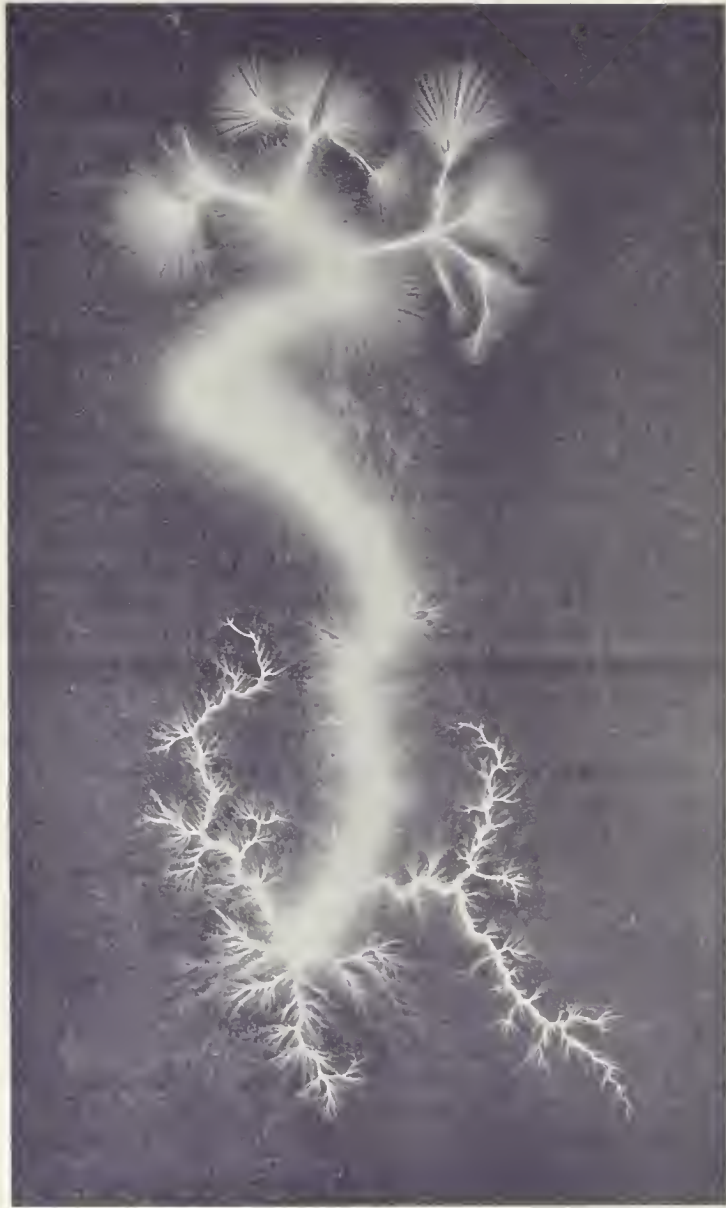
Traces laissées sur une plaque photographique par les décharges d'une électrode négative en haut et d'une électrode positive en bas.
