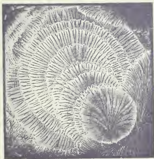
Fig VIII — Figures obtenues par impression sur des disques rigides placés très près des plaques vibrantes.
